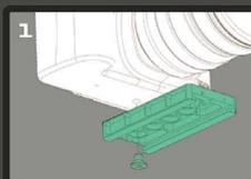
1. 取り付けるカメラの底辺にレールを取り付けます
